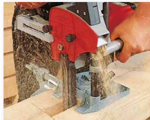
LS 103 Ec con el equipo guía FG 150 para profundidades de escopleado de hasta 140 mm.
