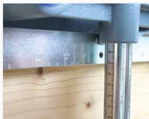
La distancia vertical de los bordes se puede ajustar con exactitud mediante una escala.
