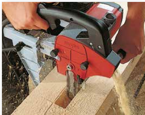
Agujeros para espigas con LS 103 Ec en distintas dimensiones hasta 100 mm.
