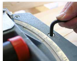
El equipo para ranurar se puede girar hasta 45° a ambos lados.
