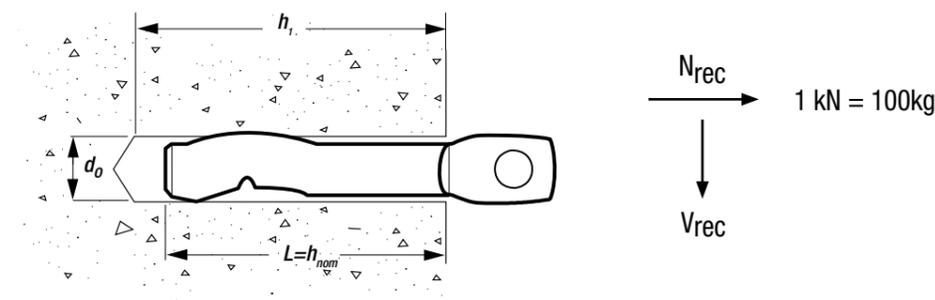
**CARGAS RECOMENDADAS - HORMIGÓN NO AGRIETADO - PERNOS PARA CONEXIÓN DE ALAMBRES SPIKE®**
