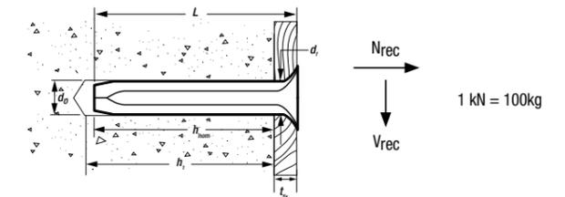
**CARGAS RECOMENDADAS - HORMIGÓN NO AGRIETADO - CLAVOS PARA FIJACIÓN**
