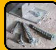
Los anclajes de tornillo pueden suministrar una fijación instantánea para dispositivos de metal y madera al hormigón, bloques y albañilería. Una vez que se haya taladrado el hueco piloto, el anclaje puede ser guiado utilizando una llave de impacto o llave de vaso manual y puede desmontarse de forma rápida y sencilla.
