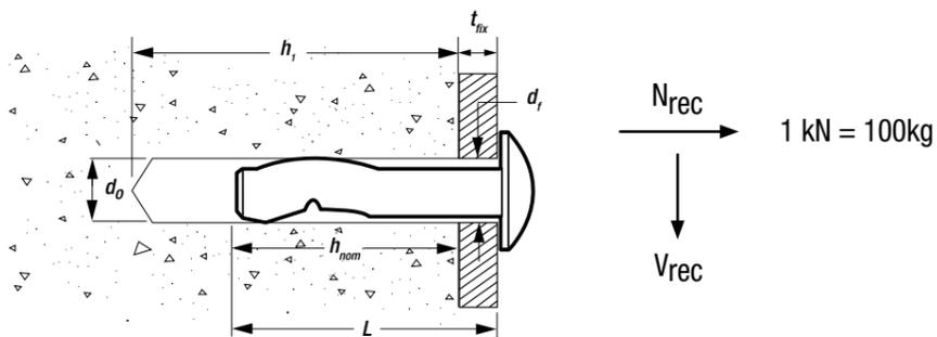
**CARGAS RECOMENDADAS - HORMIGÓN NO AGRIETADO - SPIKE™**
