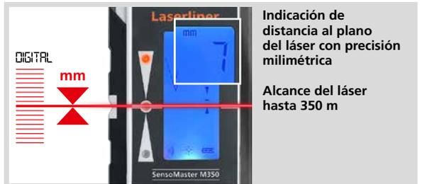
Indicación de distancia al plano del láser con precisión milimétrica
