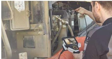
**Sistema de inspección por video profesional de alta resolución con vista frontal o lateral intercambiable**
