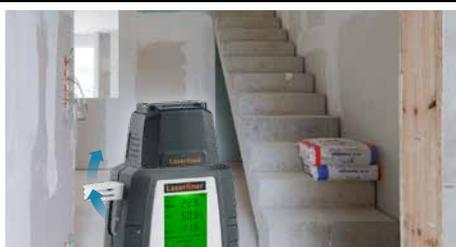
**Escanado de las superficies sin deterioro y medición puntual exacta de la humedad del material. Medición del clima ambiental con determinación del punto de condensación y interfaz de Digital Connection**
