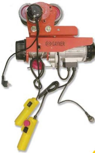
Para sujetar y desplazar polipastos eléctricos en vigas o estructuras en forma de "I".
