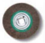
CEPILLO DE ACERO Ø 250 mm x 60 mm, con resistencia nominal muy elevada para un uso especialmente rentable, taladro de alojamiento Ø 51 mm. 0,2 mm de grosor de alambre para tubos y perfiles de paredes finas. 0,35 mm de grosor de alambre para todo tipo de aplicaciones. 0,5 mm de grosor de alambre para tubos y perfiles de paredes gruesas y una elevada potencia de desbarbado. Modelo de acero inoxidable
